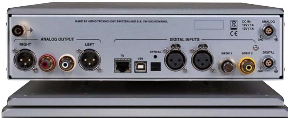
Eine hochwertige Glasfaserleitung vorausgesetzt, ist beim Nagra auch der TOSLINK-Eingang 24/192-kompatibel. Die I2S-Buchse behalten sich die Schweizer für später vor: Sie ist in keiner Form standardisiert. Ganz rechts die beiden Stromversorgungsbuchsen.
